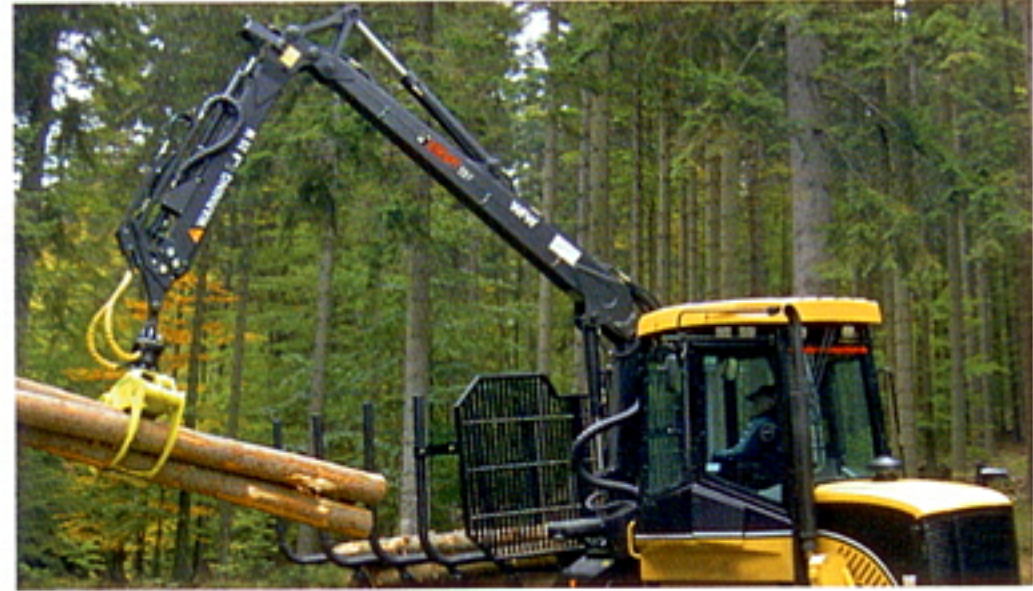
Les vérins sont dimensionnés pour les fortes pressions et les mouvements rapides
