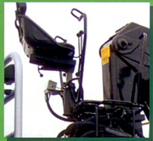
Le bloc de distribution est logé en un endroit protégé.
