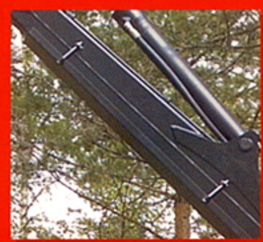
Un bouclier séparé protège le bras contre des chocs
